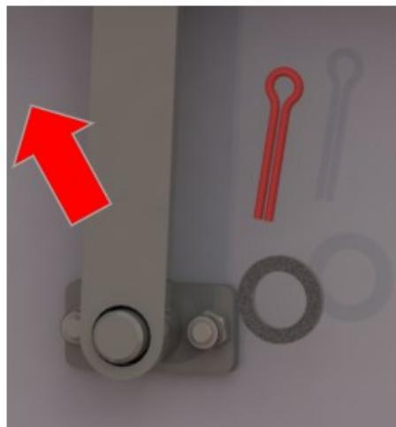
Anschließend können die Verbindungsarme gelöst und zur Seite in die Stufe geschoben werden.
